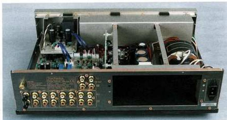
chýba čistota, prehľadnosť a logika rozmiestnenia súčiastok dôležitých pre kvalitný zvuk, zaráža ma však, že zosilňovač tejto kategórie nedisponuje symetrickými vstupnými a výstupnými linkami.
